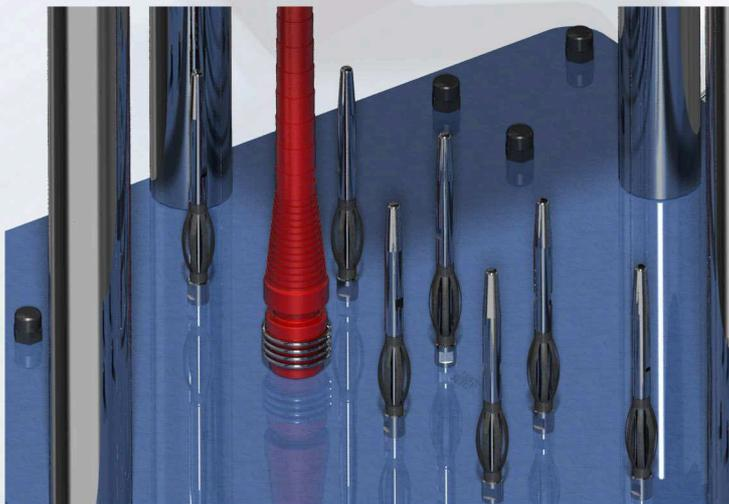
Die Anordnung, sowohl der Aufsteckspindeln als auch der Fadenbremsen und Fadenführungen, wurde der Nahtfilzproduktion entsprechend konzipiert. Jeweils 4 BCF-Einzelfäden werden linksseitig der Nahtschur geführt und 4 weitere BCF-Einzelfäden rechtsseitig. Diese Konstellation ermöglicht die Bildung einer Nahtverstärkung sowohl gewebeflächenseitig als auch schlaufenseitig.
